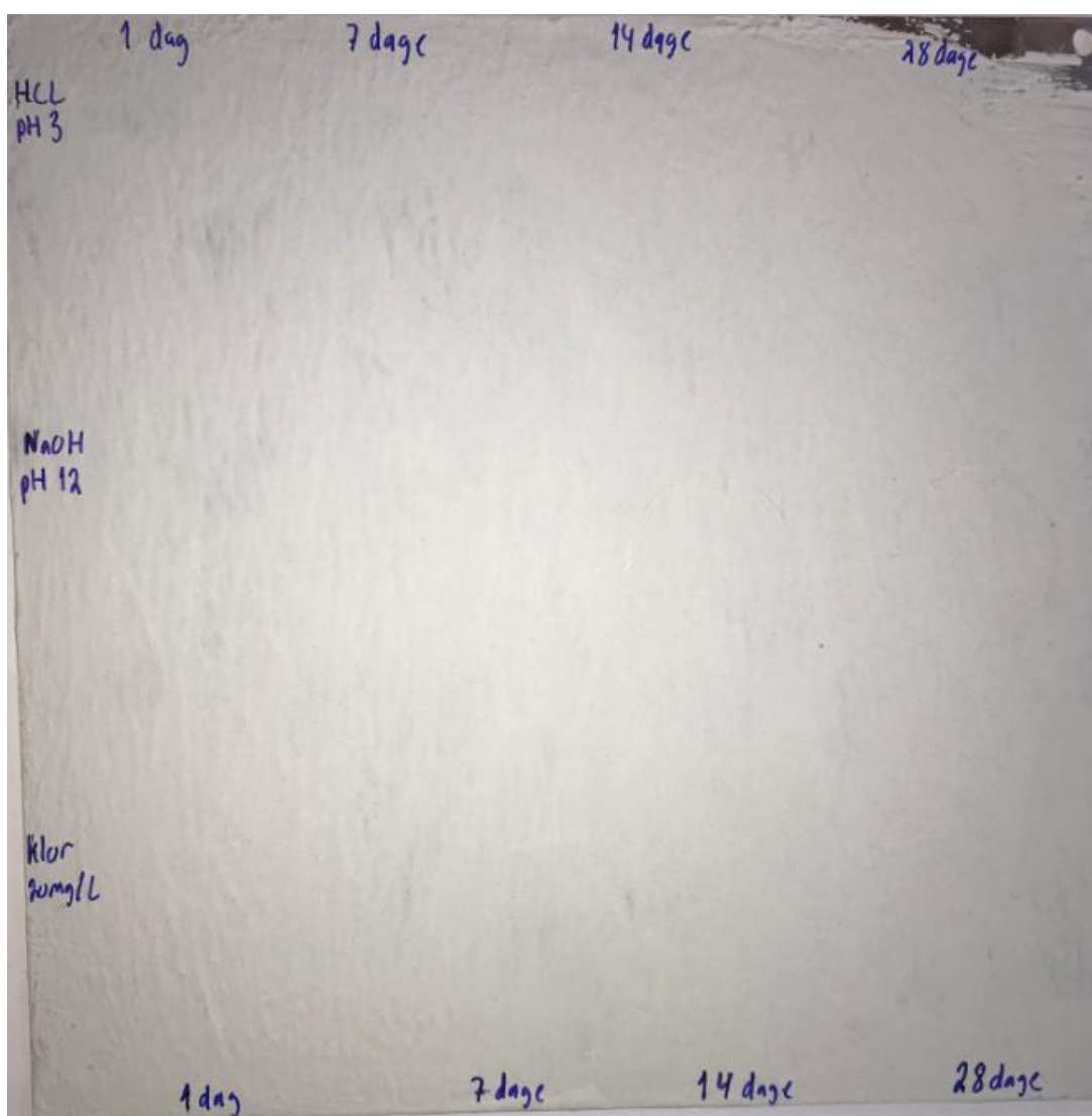
Billede 2a: Billede af testemne “uden mærkning” efter 28 dages eksponering. Urglas og filterpapir efter hhv. 1 dag, 7 dages, 14 dages og 28 dages eksponering fjernet fra testemnet. Der ses ingen tegn på ændringer i coatingen.
